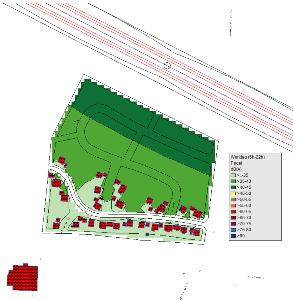
Abbildung 2 Beurteilungspegel tags an Werktagen für das EG
