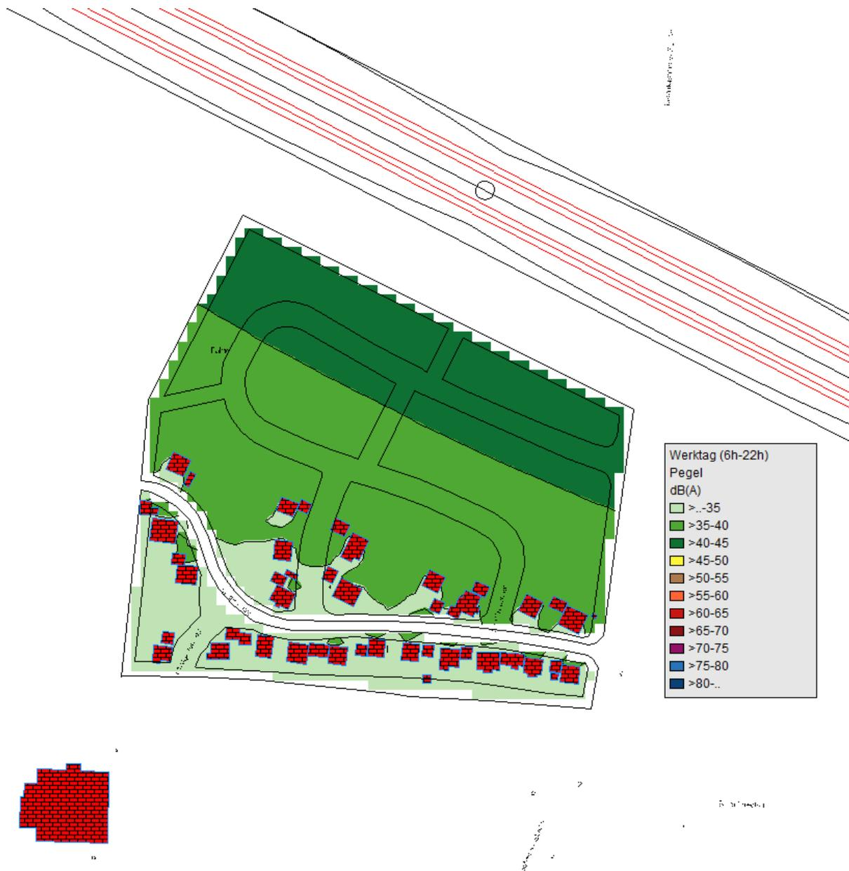
Abbildung 5 Beurteilungspegel tags an Werktagen für das 1te OG
